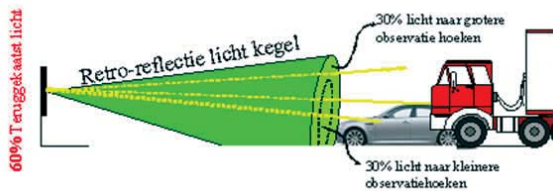
Fig 3: De nieuwste generatie micro-prismatische folie kaatst meer licht terug onder zowel grote als kleine observatiehoeken
